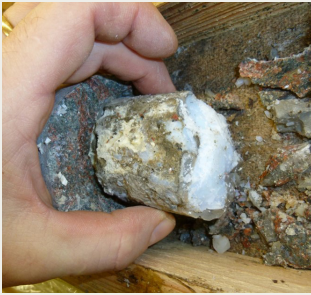
Figur 2. Bild på injekteringspluggen vid den läckande sprickan cirka 3,3 m in i kärnan.
